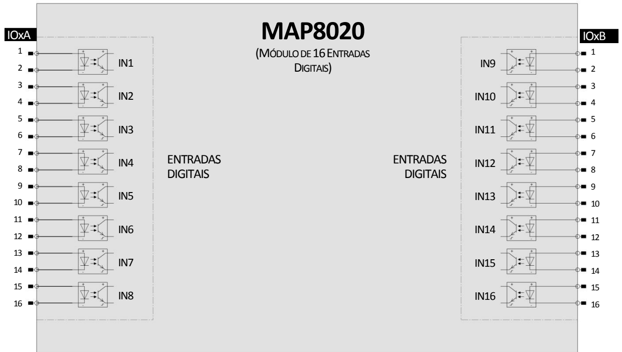
Figura 2.8. Diagrama de ligações do módulo de expansão da MAP8020.
