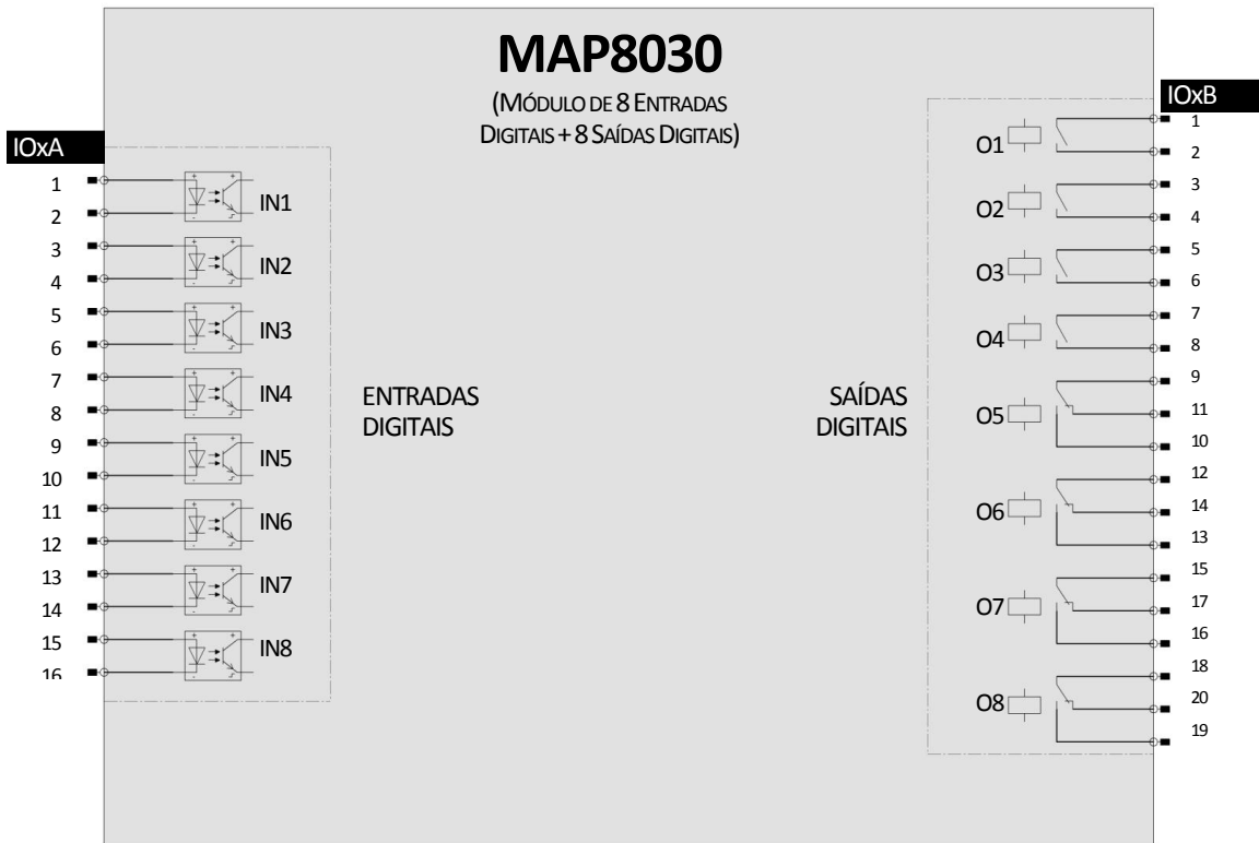
Figura 2.10. Diagrama de ligações, módulo de expansão MAP8030.
