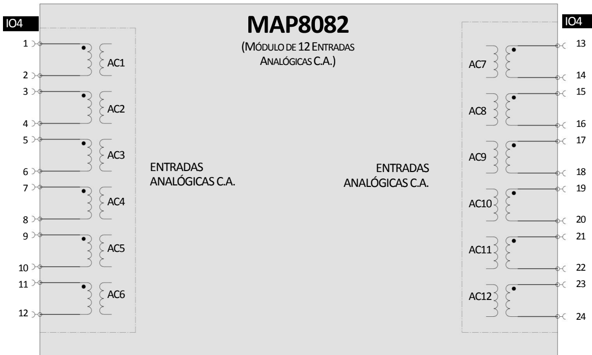
Figura 2.14. Diagrama de ligações, módulo de expansão MAP8082.
