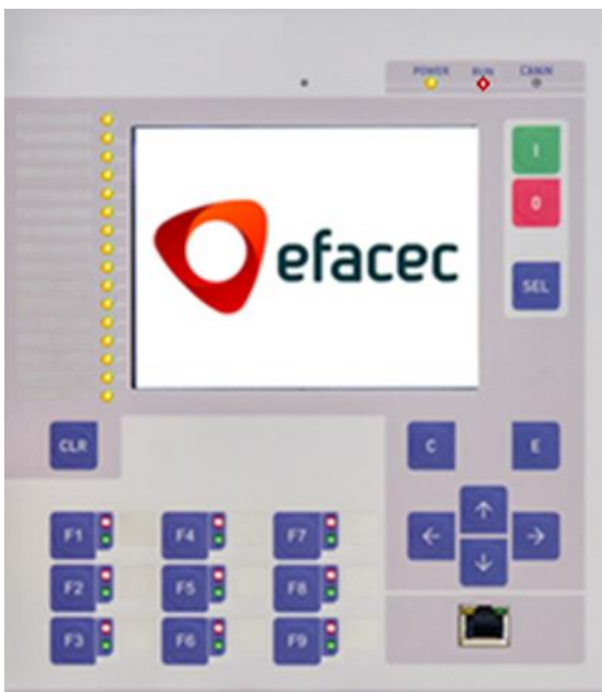
Figura 3.5. Interface Homem-Máquina local com o LED RUN vermelho a marcar uma falha completa do hardware principal.
