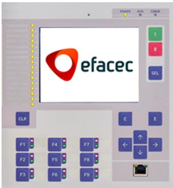
Figura 3.3. Interface Homem-Máquina local enquanto aguarda a conclusão da sequência de arranque.
